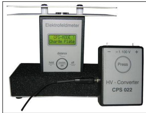
Bild rechts: Charge-Plate-Monitor mit Konverter für Test-Spannung
